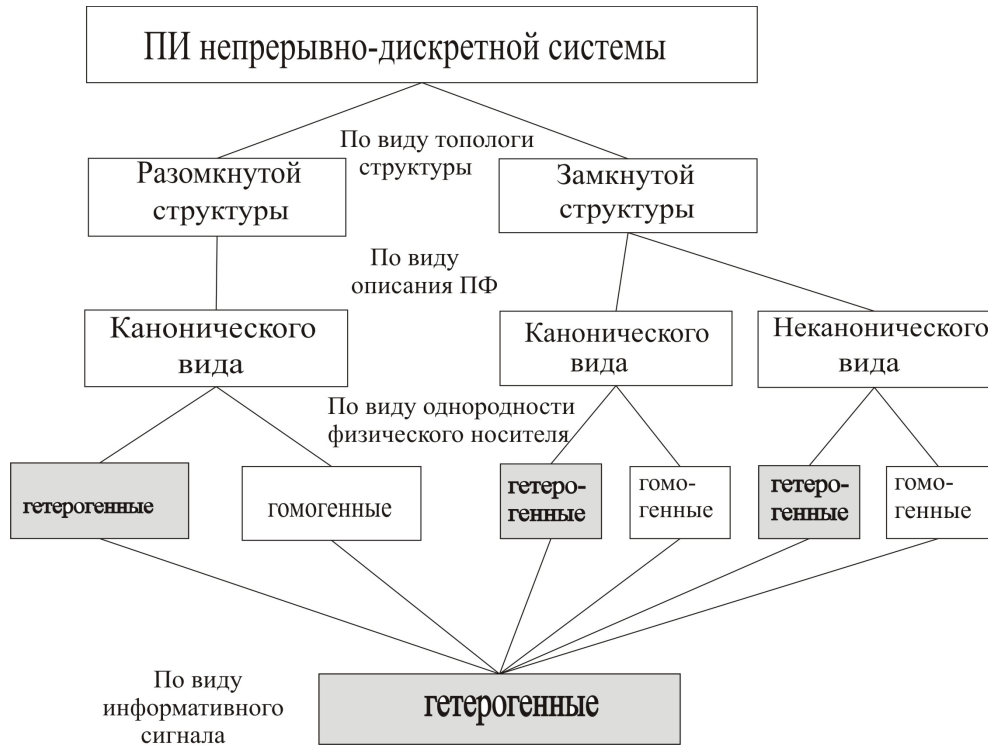
Рис. 2. Классификация измерительных преобразователей информации непрерывно-дискретной системы
